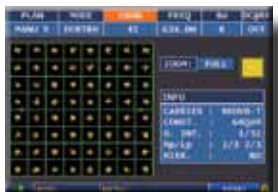
Costellaz. DVB-S2 = 8PSK, T = COFDM, C = QAM e parametri modulazione
