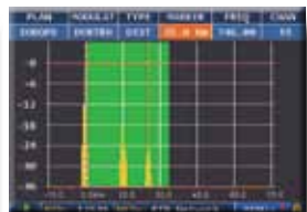
Risposta all'impulso in tempo reale (Misura ECHI e MICROECHI in RETI "SFN") Vedi pag. 22
